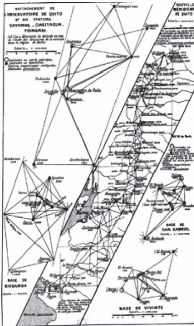
Imagen 3: Arco de meridiano, conexión del observatorio de Quito. Ver abajo (izquierda) la triangulación para la determinación de la base de Riobamba (estación de Chujuj)
